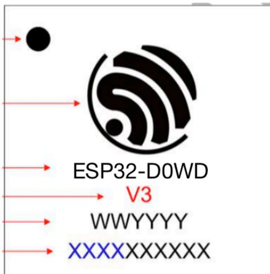
ESP32-D0WDQ6-V3 芯片丝印示意图如下：
