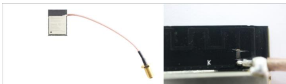
图 2-2. 模组传导测试 RF cable 接线图
